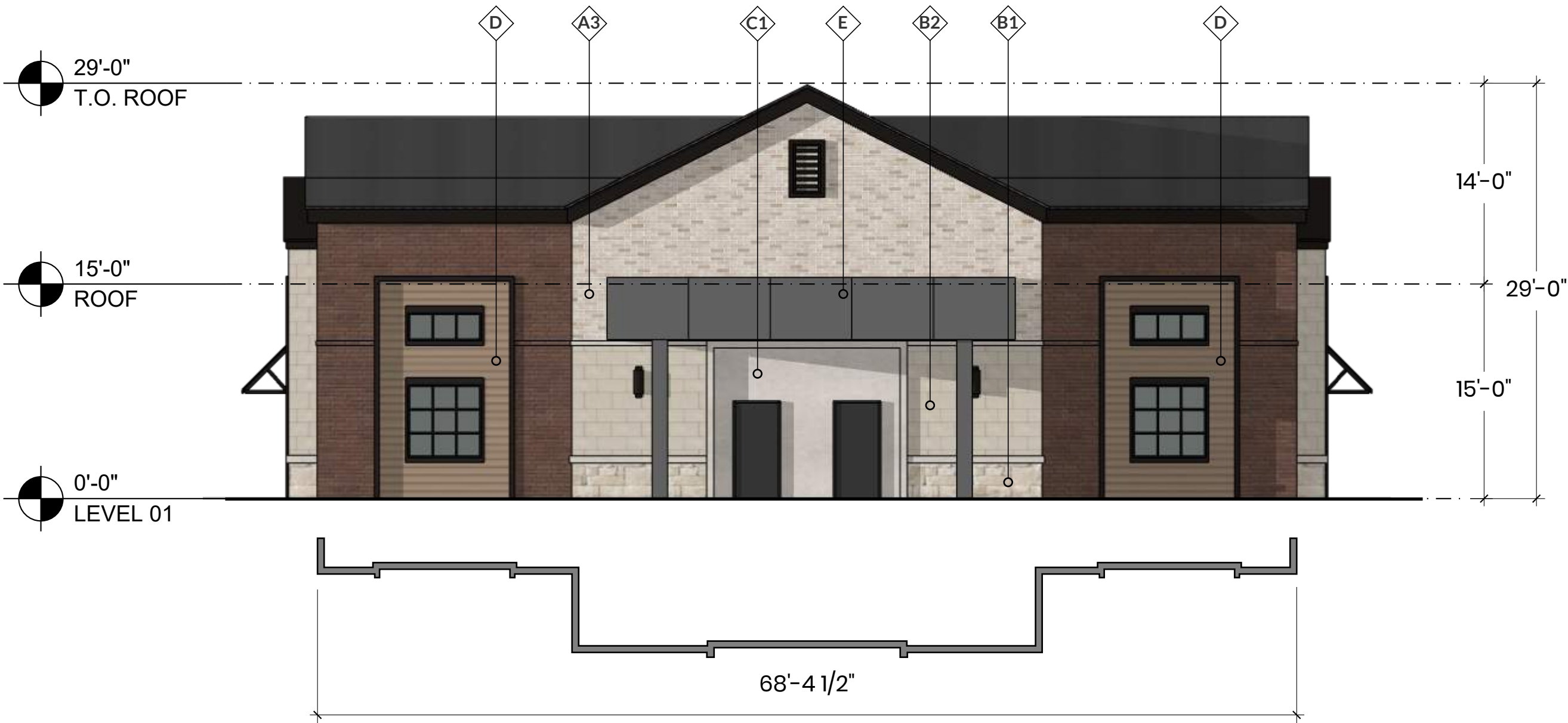
4 BACK ELEVATION - BANK SCALE: 1/8" = 1'-0"
