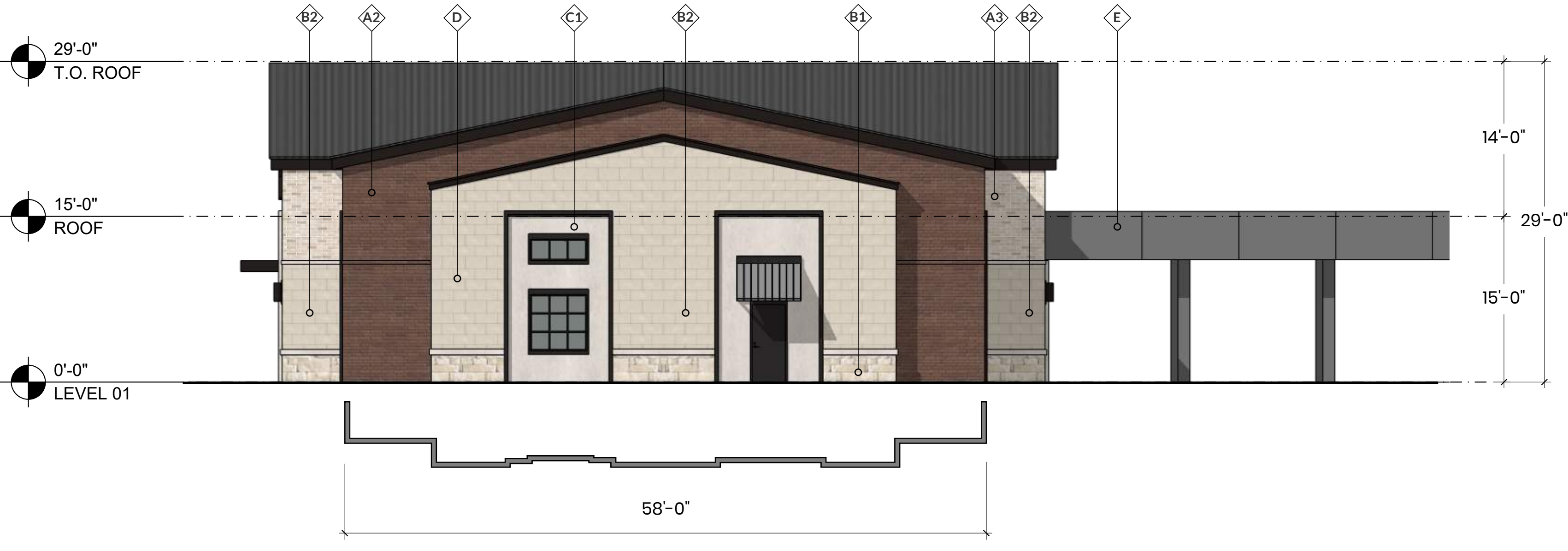
1 RIGHT ELEVATION - BANK SCALE: 1/8" = 1'-0"
