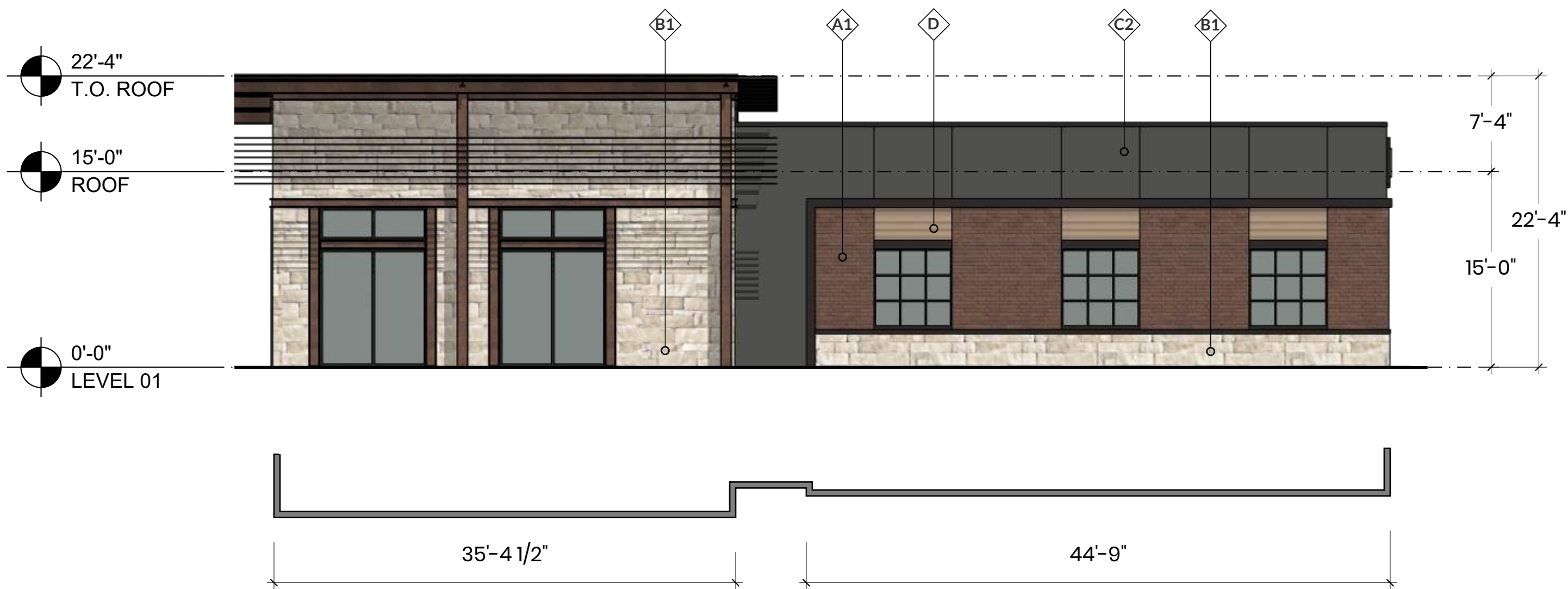
2 RIGHT ELEVATION - SIT-DOWN RESTARAUNT SCALE: 1/8" = 1'-0"
