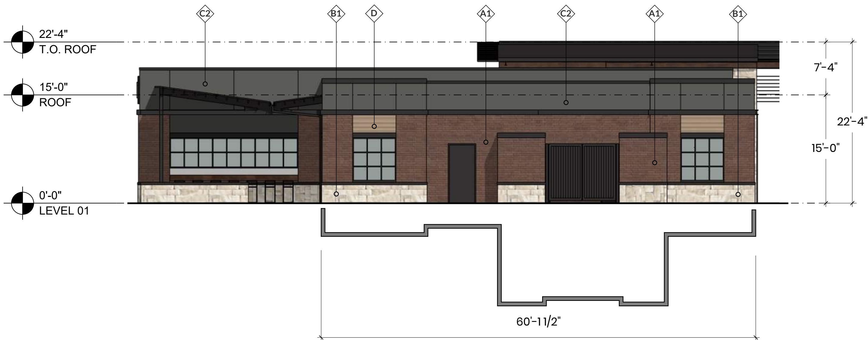
1 RIGHT ELEVATION - SIT-DOWN RESTARAUNT SCALE: 1/8" = 1'-0"
